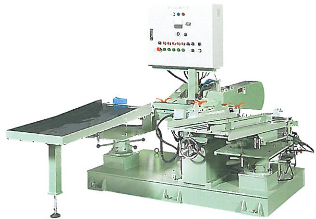
エンドレスベルト型 自動供給・排出装置付き With automatic charging/discharging devices.
